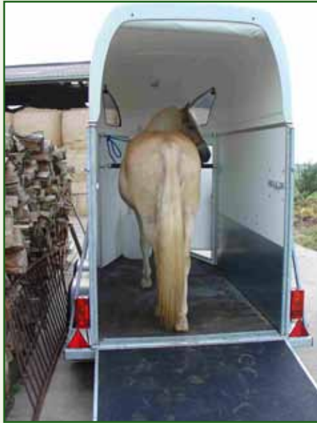
Afbeelding 36: Een licht dak en een geopende voordeur vergemakkelijken het op de van laden
