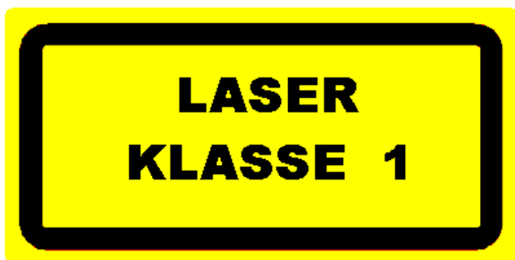
Op een toestel aangebrachte vermelding van de klasse, conform EN 60825.
