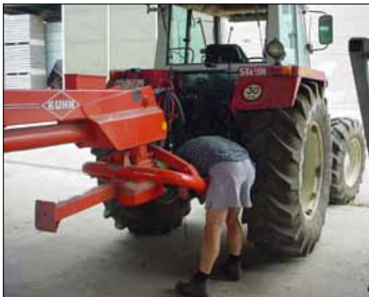
De bestuurder heeft geen goed zicht op personen die dicht bij de tractor staan (12)
