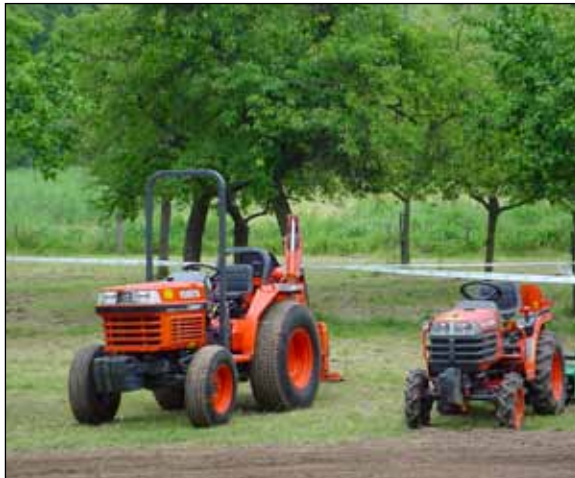
Minitractor met veiligheidsbeugel
