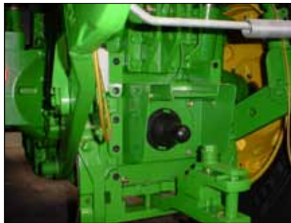
Uiteinde van de aftakas en beschermkap
