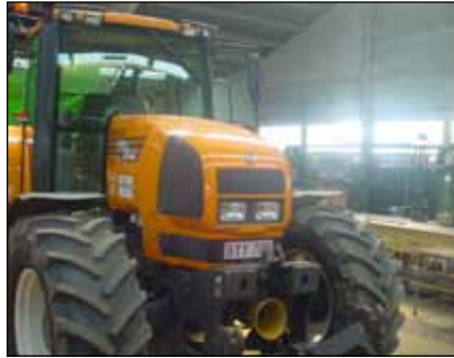
Uiteinde van de aftakas vooraan en beschermkap
