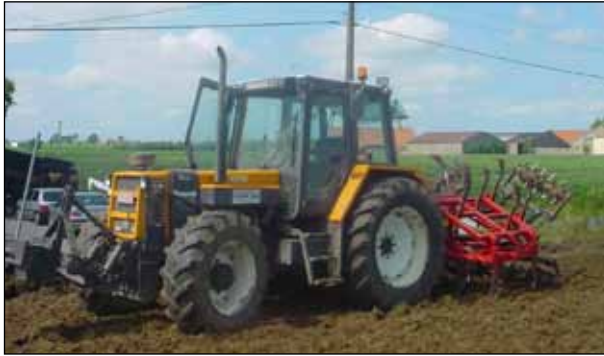
Tractor met vierwielaandrijving en veiligheidscabine
